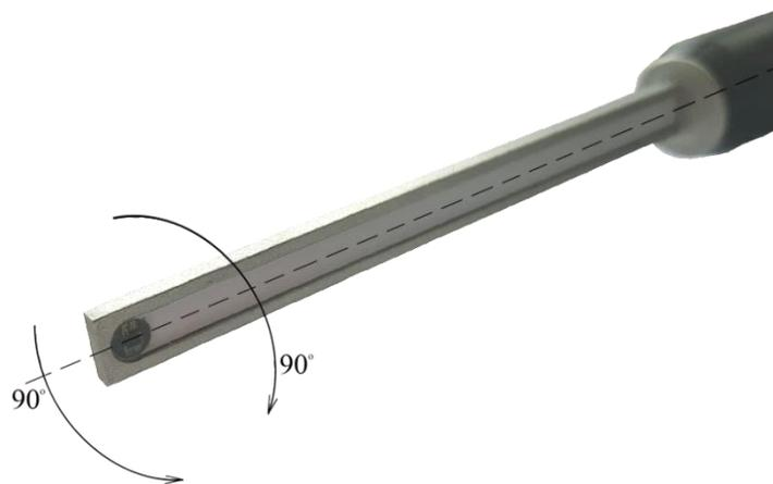
Рисунок 2.13 – Переворот преобразователя на 90° относительно своей оси
