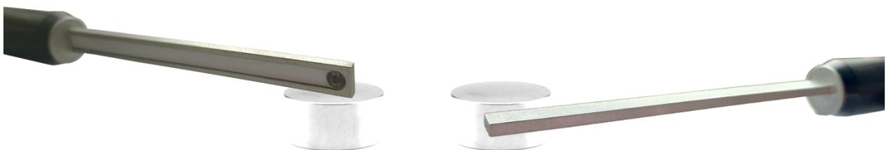
Рисунок 2.15 – Измерение тангенциальной составляющей вектора индукции магнитного поля на торцевой и боковой поверхности изделия
