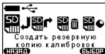
Рисунок 2.23 – Создание резервной копии калибровок
