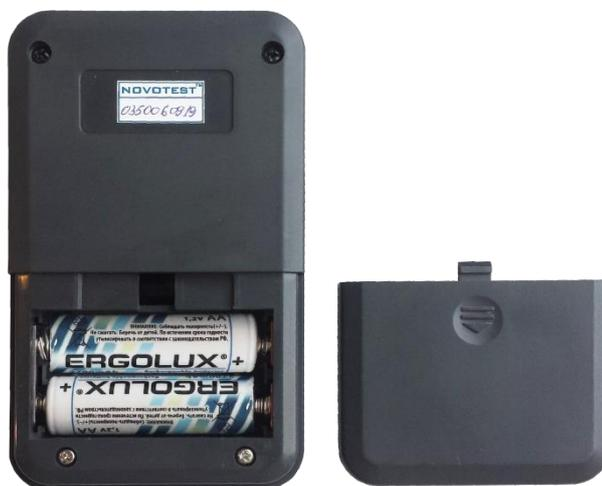
Рисунок 2.1 – Установка элементов питания
