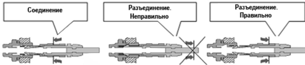
Рисунок 2.4 – Манипулирование разъемами
