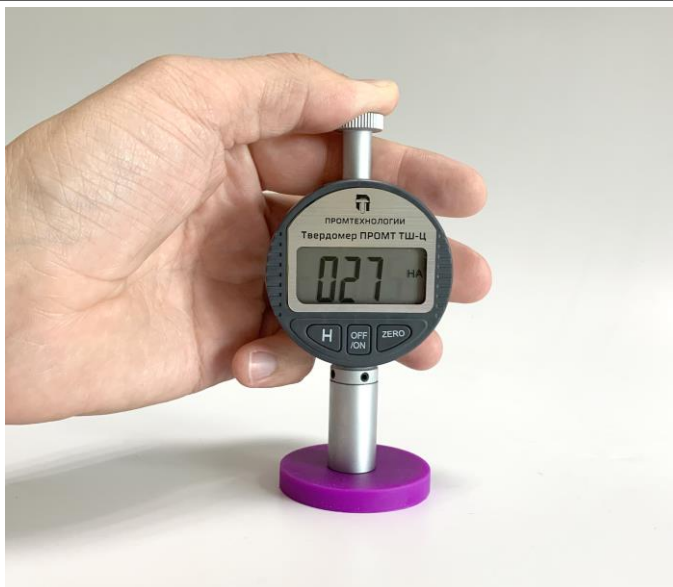
Рисунок 2.2 – Твердомер ПРОМТ ТШ-Ц во время проведения измерения
