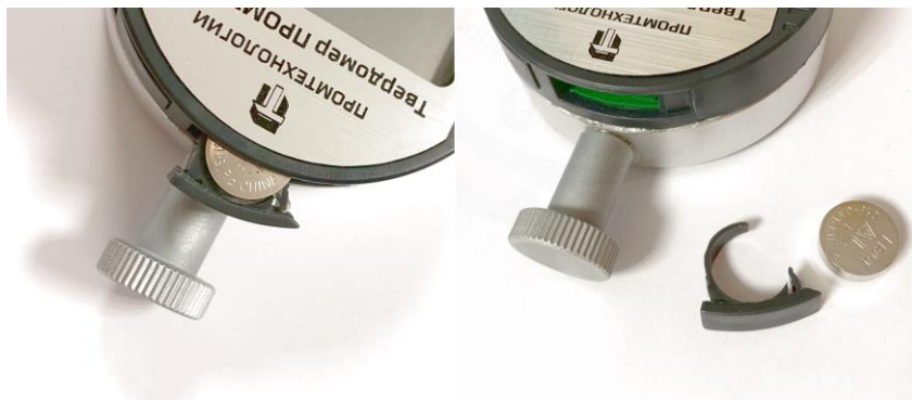
Рисунок 2.1 – Установка/замена элемента питания
