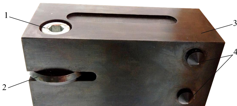
1 – винт фиксации индентора; 2 – индентор; 3 – корпус; 4 – заостренные ножки.
