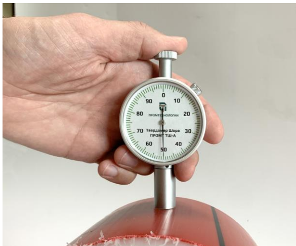
Рисунок 2.2 – Твердомер ПРОМТ ТШ-А во время проведения измерения
